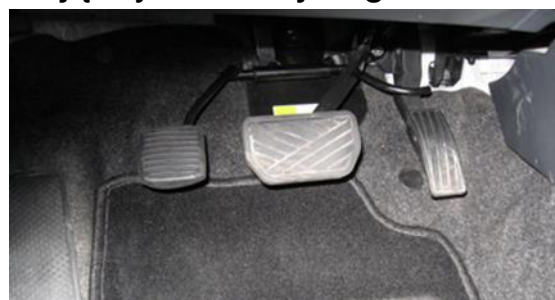
Przełożenie pedału na lewą stronę [źródło: http://autosprawni.pl/k4/index.html ]
