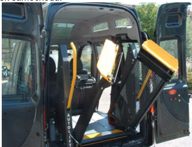
Rys. 3.35. Winda BBW 1600 [źródło: https://asdon.pl/category/pasazer/windy/ ]
