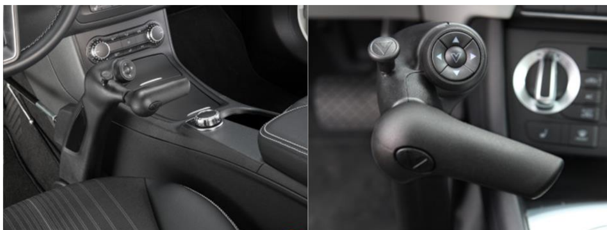
Rys. 3.23. Dźwignia Veigel Classic II [źródło: https://emico.pl/oferta/dostosowanie-samochodu/reczne-sterowanie-gazem-i-hamulcem/veigel/veigel-classic-ii-druga-generacja-klasyki.html ]
