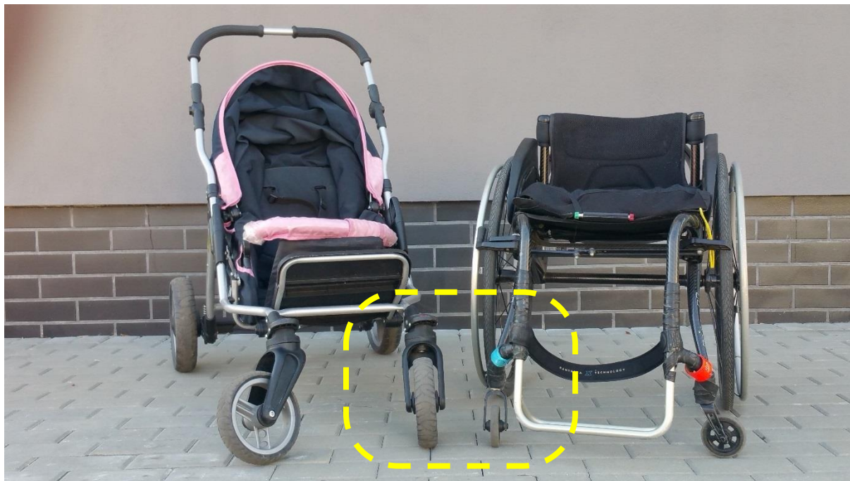
Rys. 20. Wózek dziecięcy (po lewej) z inwalidzkim (po prawej) ustawione do porównania szerokości ich przednich kół skrętnych (fot. własna)
