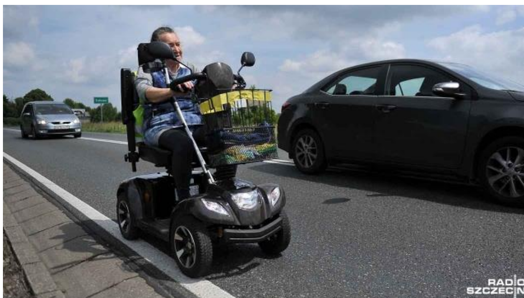
Rys. 36. Problem z ustępowaniem wózkiem inwalidzkim miejsca nadjeżdżającemu pojazdowi przy poboczu częściowo utwardzonym płytami chodnikowymi [89]
