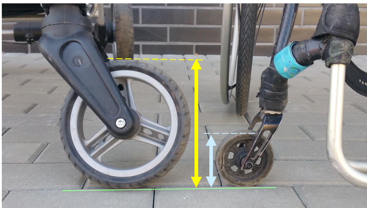
Rys. 19. Porównanie średnic przednich kół wózka dziecięcego (po lewej) z inwalidzkim (po prawej) (fot. własna)
