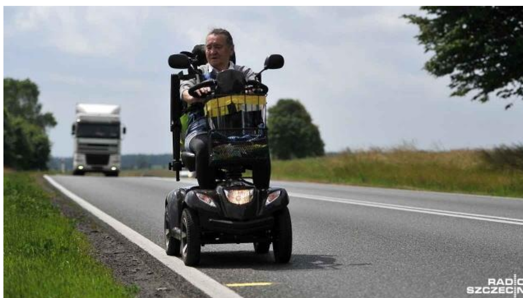
Rys. 34. Problem z ustępowaniem wózkiem inwalidzkim miejsca nadjeżdżającemu pojazdowi przy poboczu nieutwardzonym trawiastym [89]
