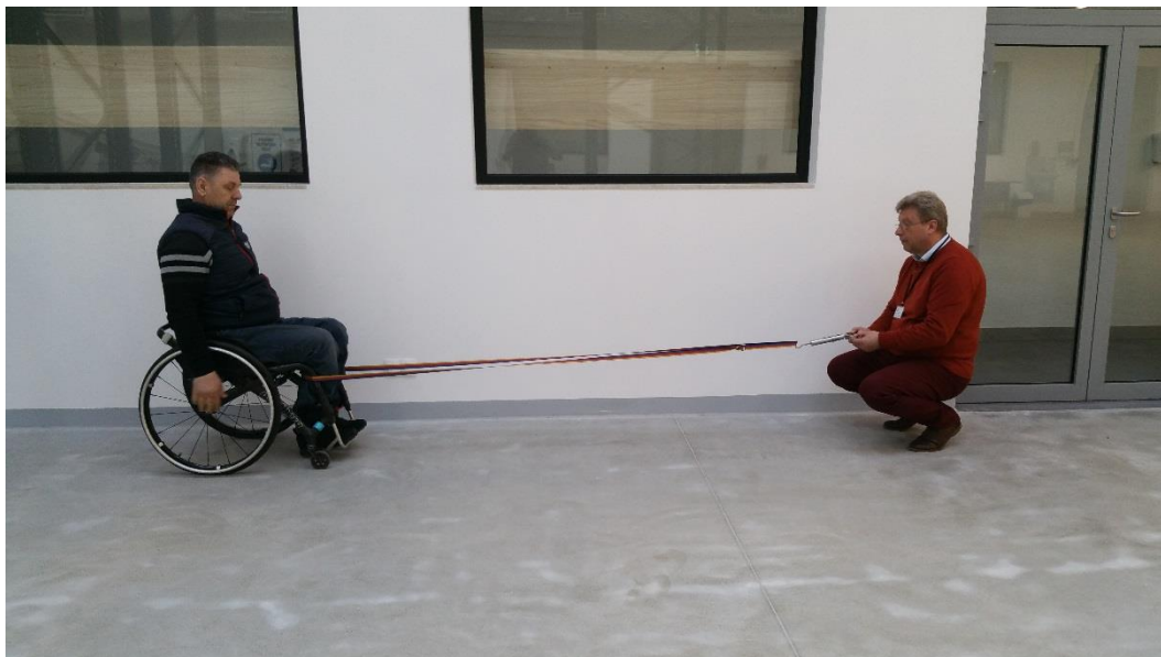
Rys. 42. Pomiar oporów ruchu aktywnego wózka inwalidzkiego na gładkim betonowym podłożu przy pionowej pozycji osoby znajdującej się na wózku (fot. własna)
