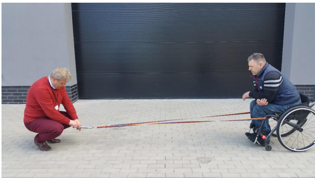
Rys. 43. Pomiar oporów ruchu aktywnego wózka inwalidzkiego na nawierzchni z kostki brukowej przy pochylonej pozycji osoby znajdującej się na wózku (fot. własna)
