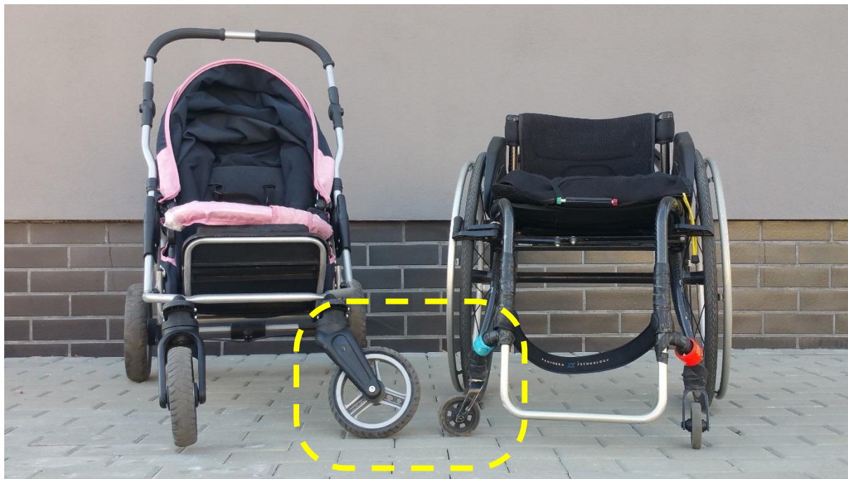
Rys. 18. Wózek dziecięcy (po lewej) z inwalidzkim (po prawej) ustawione do porównania średnic ich przednich kół skrętnych (fot. własna)
