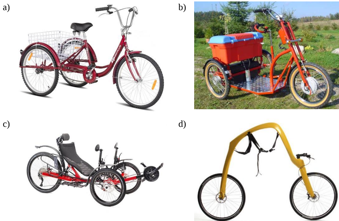
Rysunek 3.3. Widok konstrukcji rowerów o różnej pozycji przyjmowanej przez kierującego podczas jazdy.
