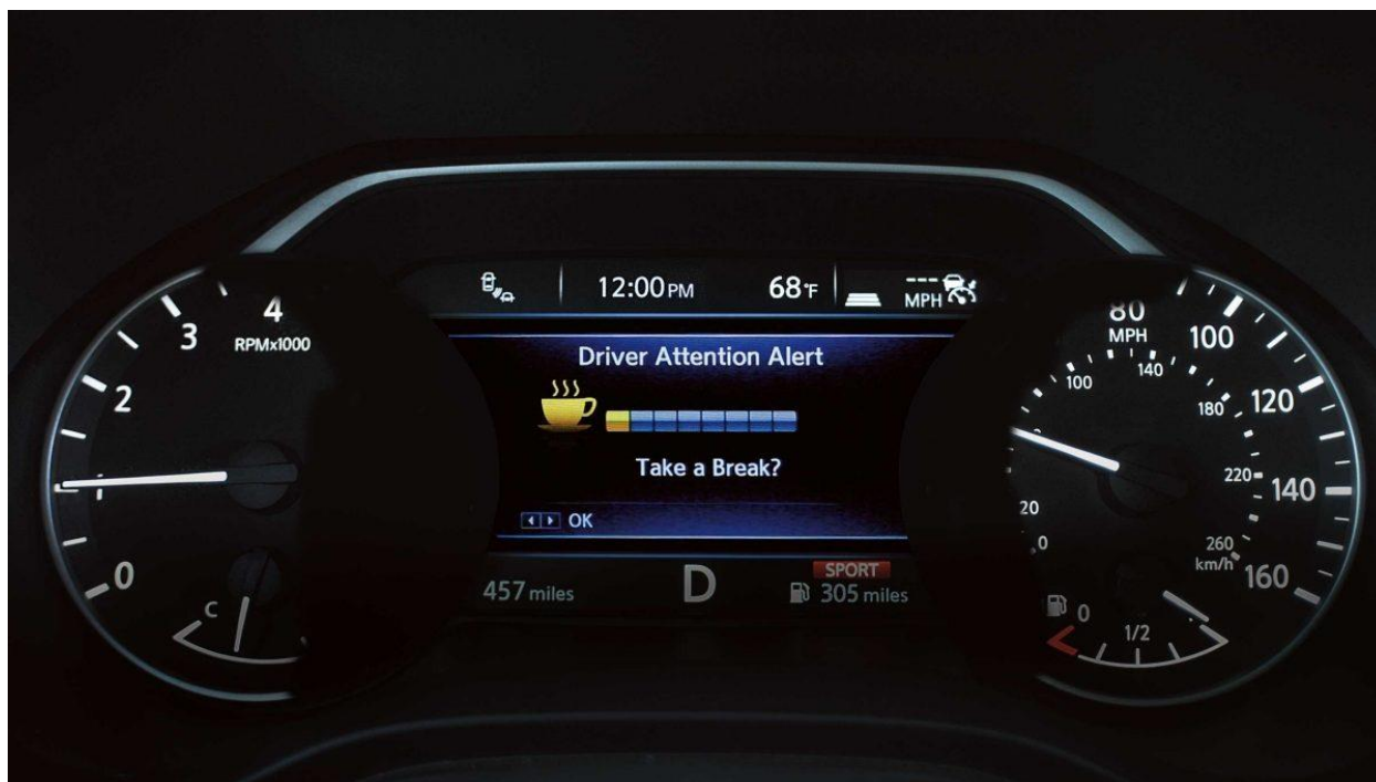
Rys. 7 Przykładowa sygnalizacja o ostrzeżeniu kierowcy przez system DAA (18)
