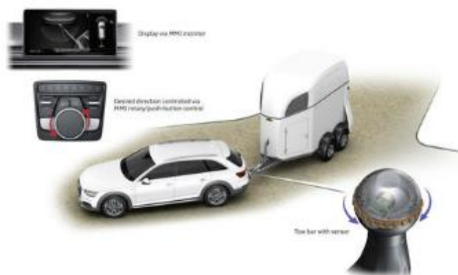
Rys. 2.13. Ilustracja działania systemu cofania z przyczepą [28]
