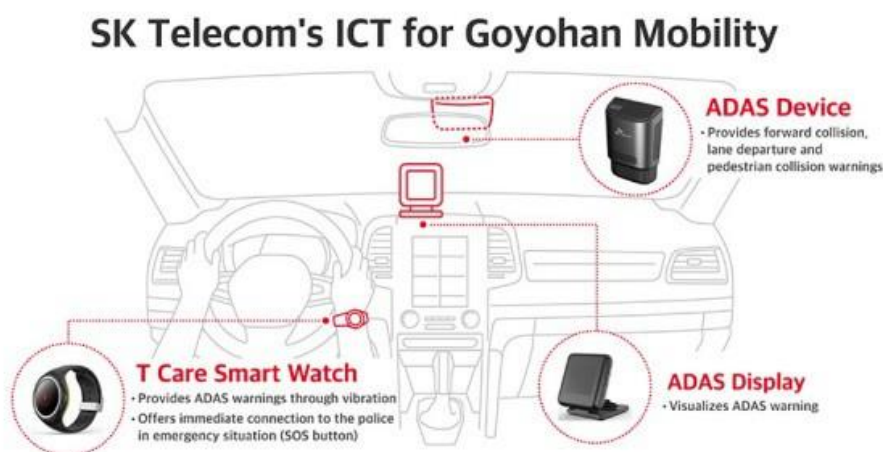
Rys. 3.3. Idea systemu firmy Goyohan [25]
