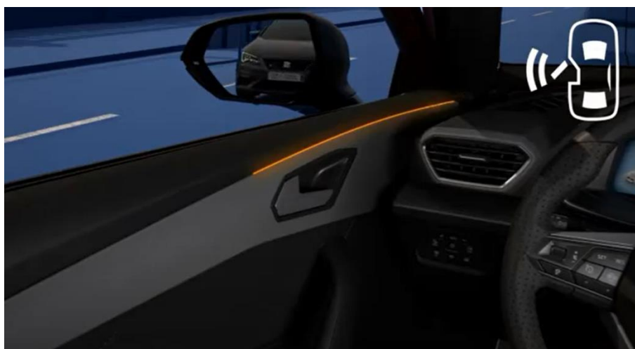
Rys. 2.15. Ilustracja działania system Exit Warning w samochodzie Seat Leon [19]
