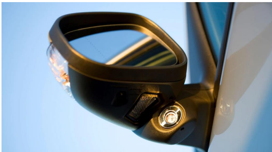
Rys. 2.6. Kamera zamontowana pod lusterkiem bocznym [11]
