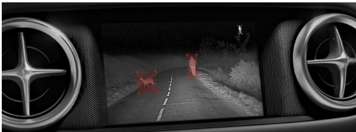
Rys. 2.16. Przykład rozpoznawania osób i zwierząt w systemie night vision samochodu Mercedes [29]
