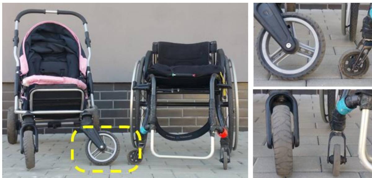
Rys. 4.5. Wózek dziecięcy (po lewej) z inwalidzkim (po prawej) ustawione do porównania średnic oraz szerokości ich przednich kółek skrętnych (fot. Z.Sobczyk)
