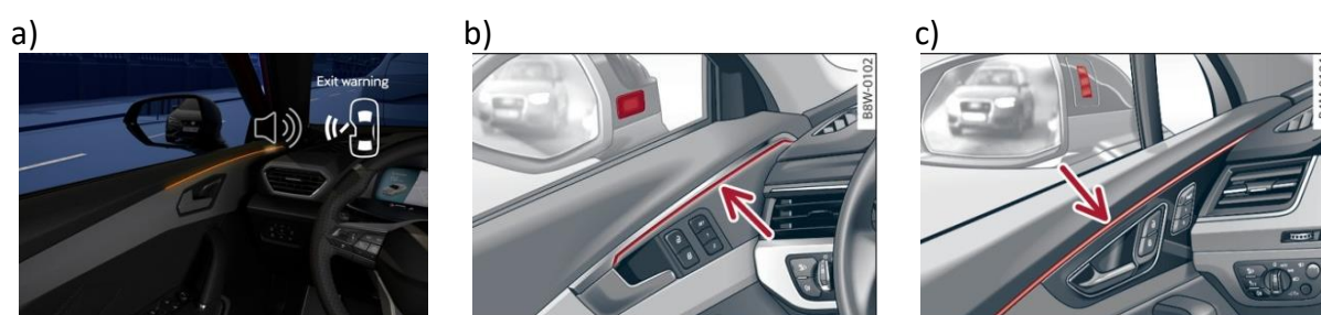
Rys.8. Przykłady wizualnych ostrzeżeń o zagrożeniu kolizją z otwieranymi drzwiami w trzech wybranych samochodach. a) Seat - Leon, b) Audi A4, c) Audi Q7
