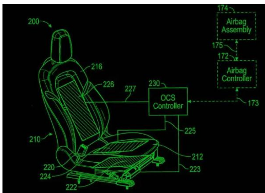
Rys. 2.8. Schemat systemu poduszki gazowej Tesli [18]
