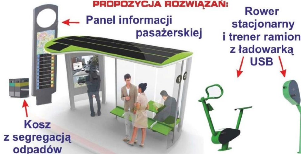
Rys. 50. Rozbudowana wersja koncepcji łomżyńskiego przystanku Smart City [11]
