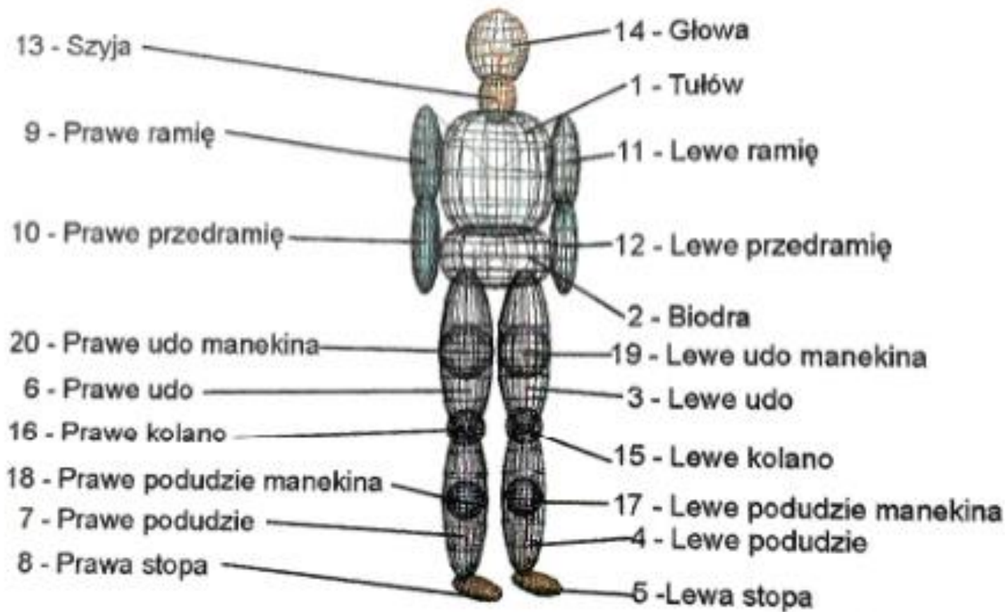
Układ wielobrytowy manekina antropomorficznego w PC-Crash
