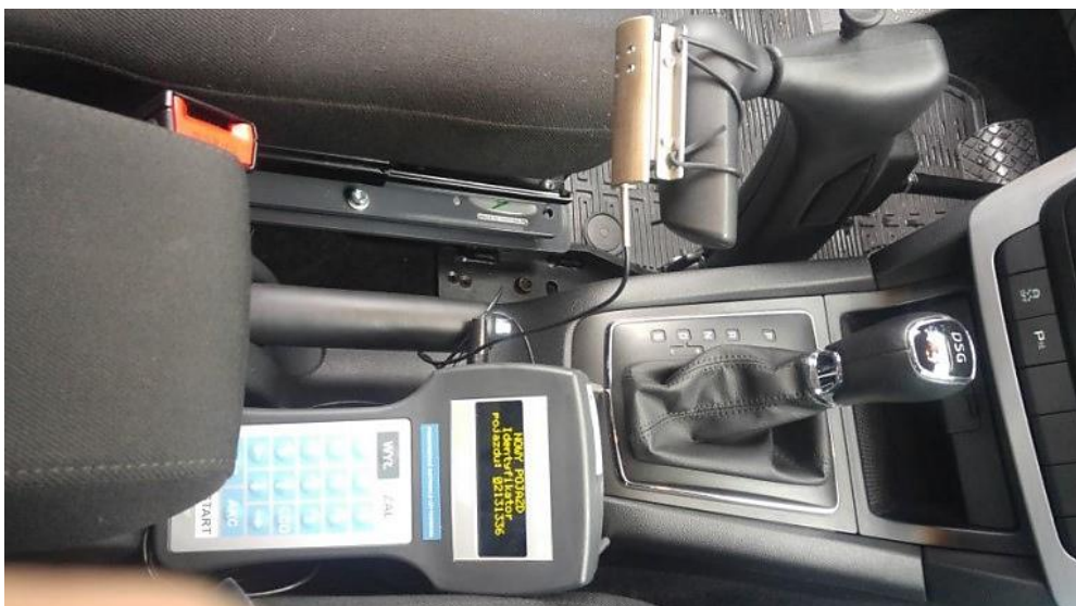
Rys. 7. Opóźniomierz zamontowany w Skodzie Yeti (Fot. A. Sowiński, ITS)
