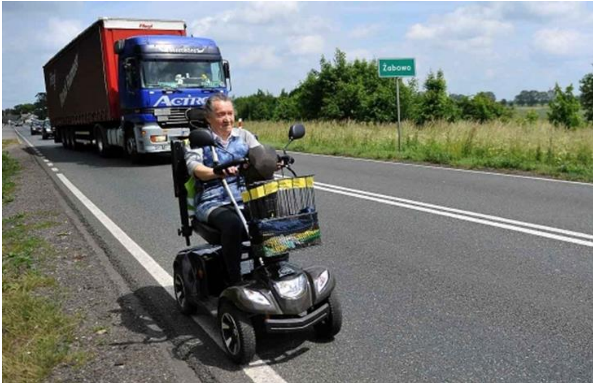
Rys. 4.8. Problem z ustępowaniem wózkiem inwalidzkim miejsca nadjeżdżającemu pojazdowi przy poboczu nieutwardzonym trawiasto-mieszanym [30]
